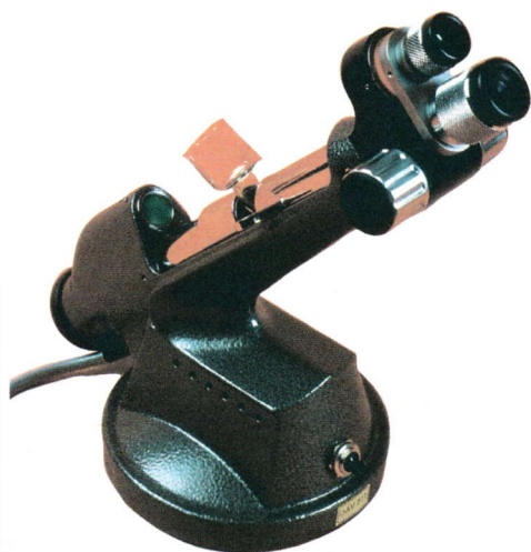
Figura 6. El polarímetro se utiliza para cuantificar la actividad óptica de los compuestos orgánicos.
