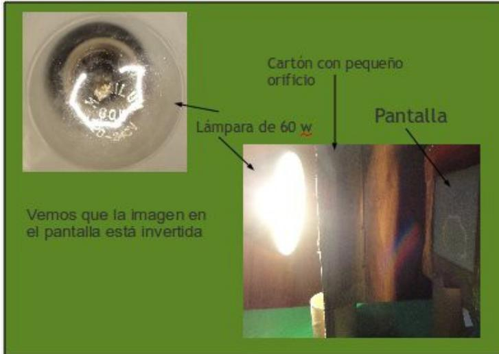
Una lámpara incandescente de 60W ilumina un orificio circular de menos de 1mm de diámetro.
